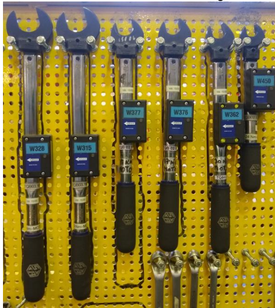
Figura 28: Torquímetros Sturtevant Richmond na linha de montagem
