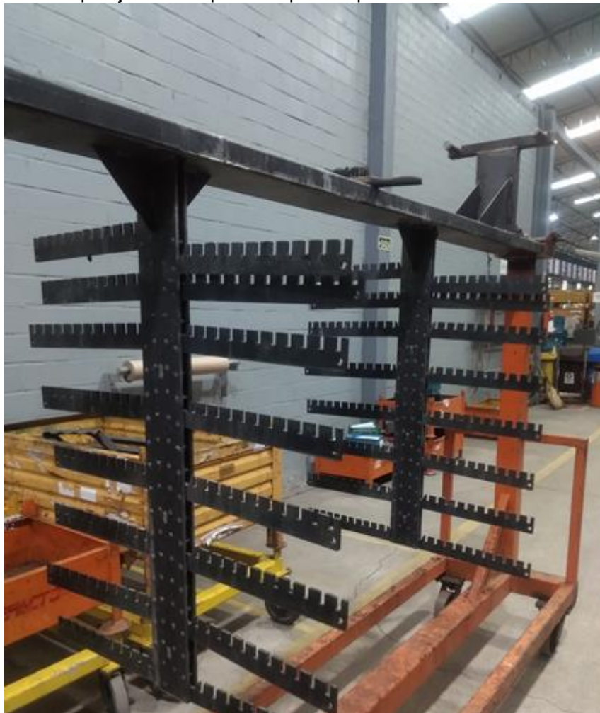
Figura 33 – Carro de disposição dos dispositivos para limpeza
