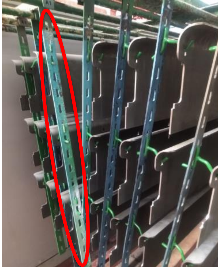
Figura 20 – Gancheiras com remoção de tinta no banho de desengraxante
