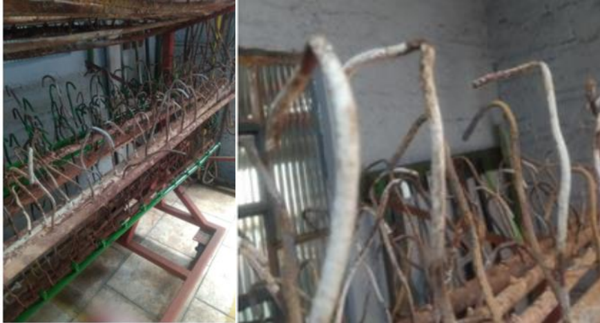
Figura 22 – Ganchos danificados pelo processo de limar
