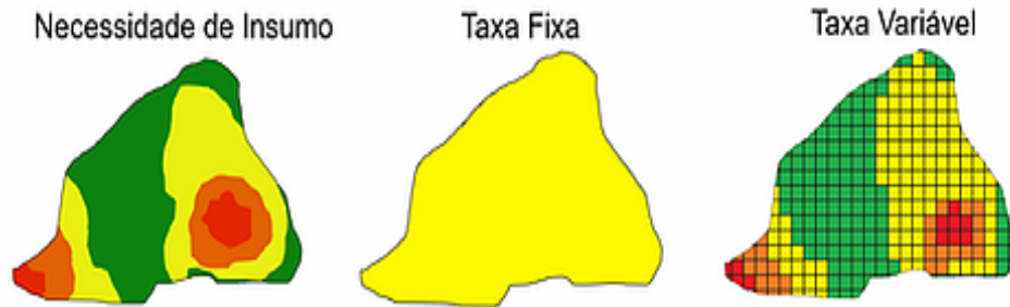
Figura 2- ilustração do sistema de aplicação de taxa variável.
