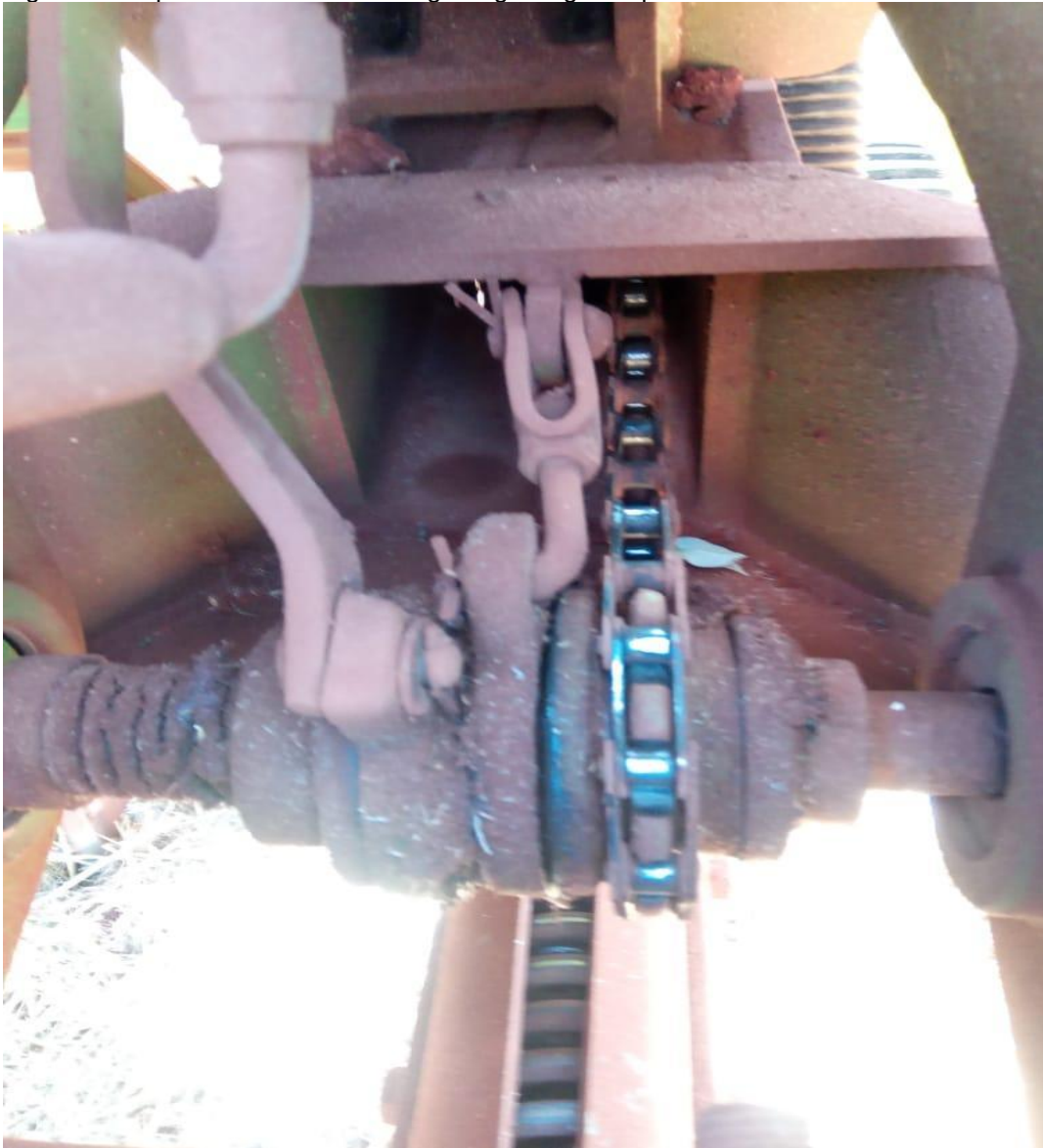
Figura 7 - Representa sistema de engrenagem ligadas por corrente
