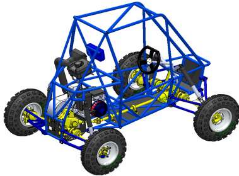
Figura 43 – Sistema de transmissão em montagem completa
