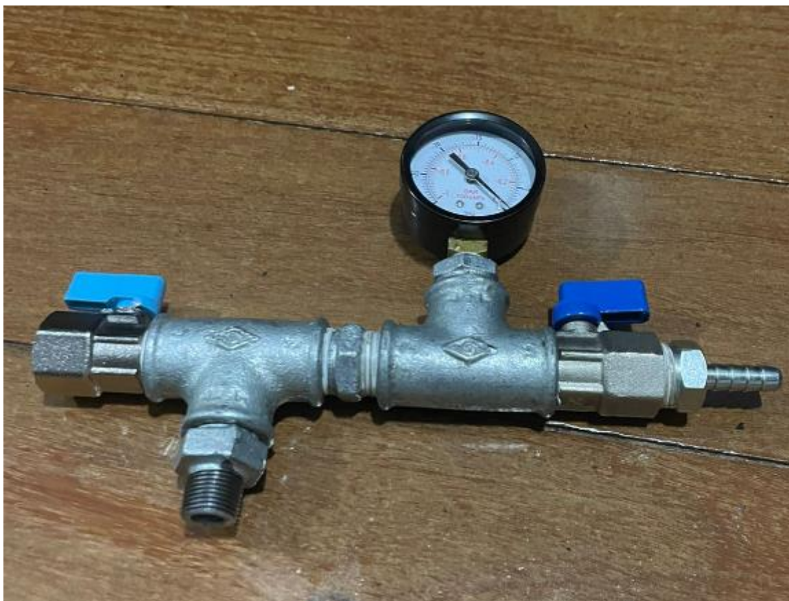
Figura 14 — Sistema de válvulas, conexões e vacuômetro montado
